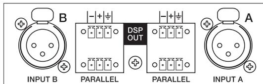
Die Eingänge INPUT A & INPUT B sind elektronisch symmetrisch mit einer Eingangsempfindlichkeit von +6dBu (1.55V) für den direkten Betrieb mit Mischpulten usw. ausgelegt.
